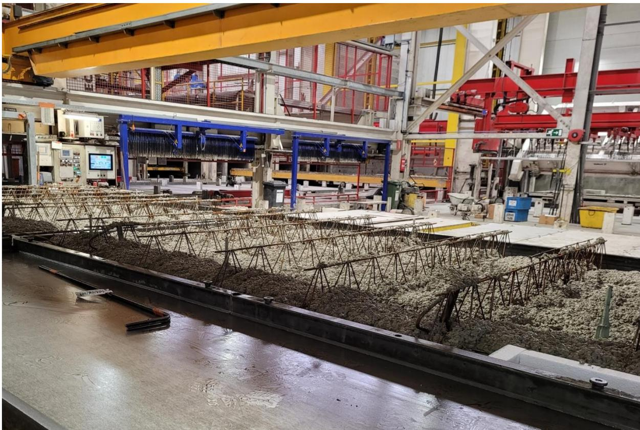
Concreto após o processo oscilatório
