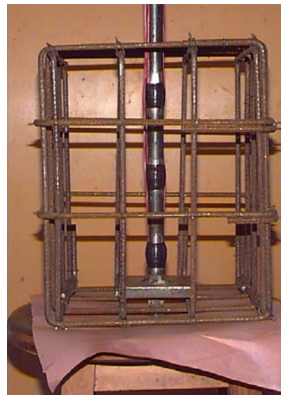
Figura 5.3 - Armadura do bloco e chumbador.
