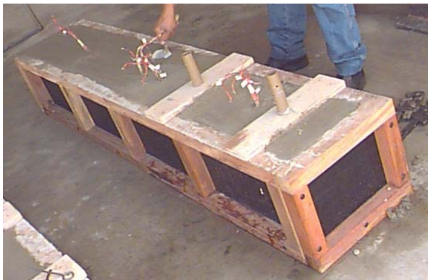
(b) - Viga depois de moldada.
