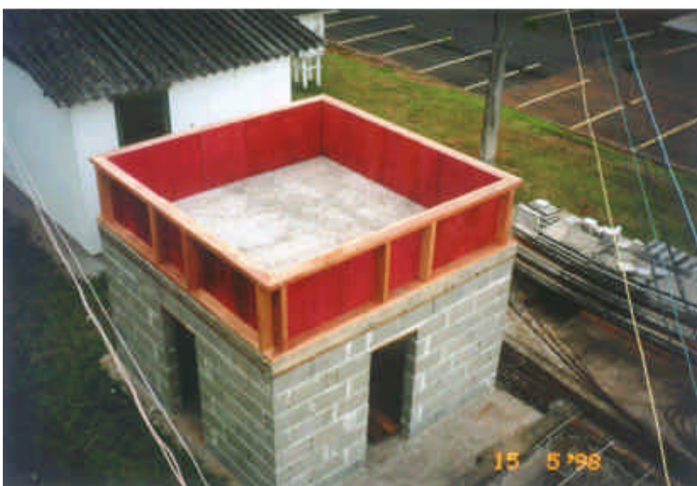
Fig.5.3 Vista geral do protótipo e do suporte de madeira utilizado para o carregamento com água
