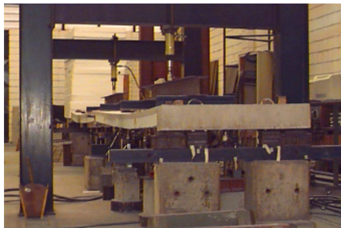
FIGURA 5.2 – Ensaio da faixa de laje nas etapas finais de carga
