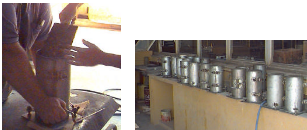
FIGURA 4.32 – Moldagem dos corpos-de-prova
