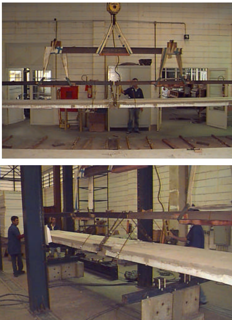
FIGURA 4.22 – Içamento e colocação da estrutura na posição de ensaio
