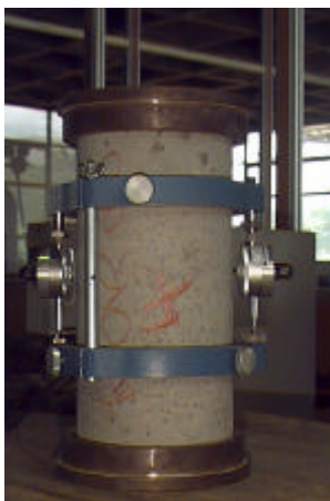
FIGURA 4.33 – Preparação do corpo-de-prova de concreto para ensaio de determinação de módulo de elasticidade
