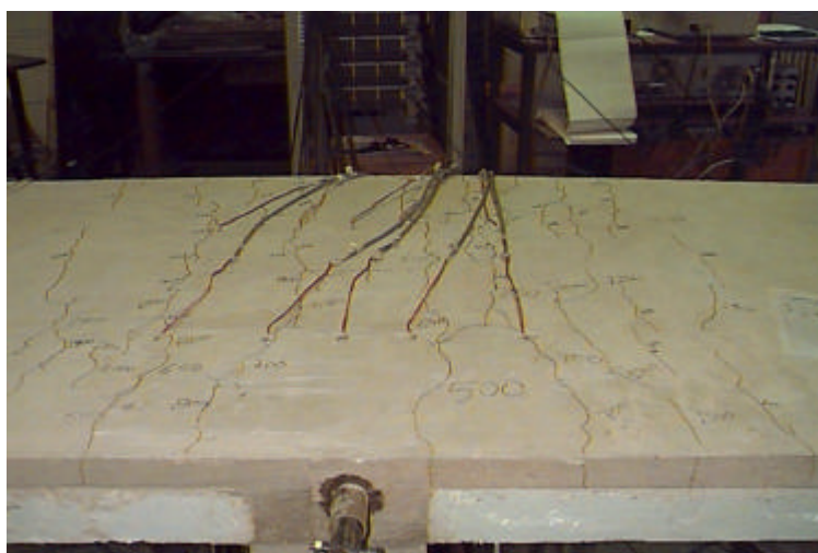
FIGURA 4.47 – Fissuração devido ao momento fletor negativo – modelo M15
