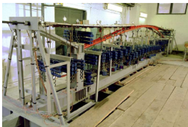
Figura 62 – Passarela em Plzen – modelo estático. (STRASKY, 1999)
