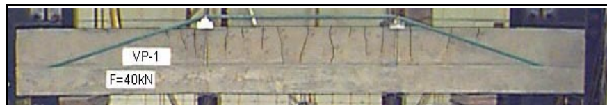
Após a protensão dos cabos.
