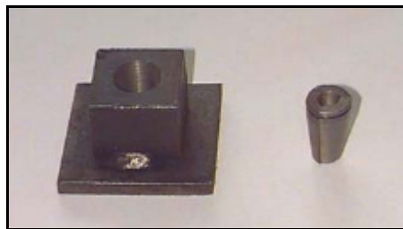
Figura 4.9 - Porta cunha e cunha para ancoragem
