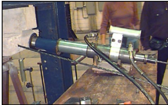
Figura 4.19 - Detalhe do macaco durante a protensão do primeiro cabo da VP-1
