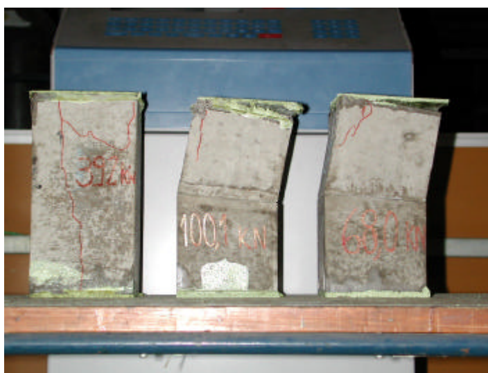
Figura 4.68 –Carga máxima aplicada ( i = 10\% e e = 10\text{mm} ) – V5L30F3
