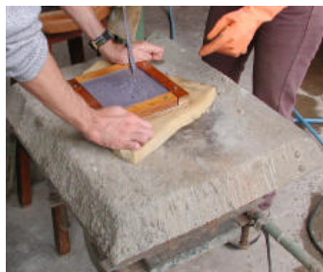
Figura 3.14 – Adensamento em mesa vibratória, após aplicação da fibra de PVA
