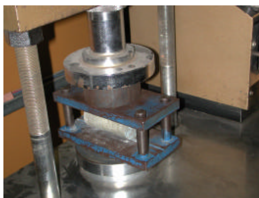
Figura 3.6b – Ensaio de tração por compressão diametral (b)
