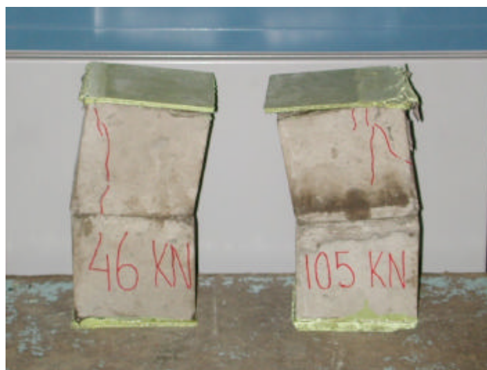
Figura 4.69 –Carga máxima aplicada ( i = 10\% e e = 10\text{mm} ) – V25L30VD2
