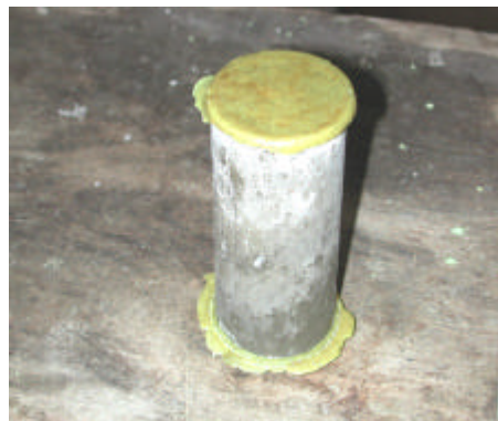
Figura 3.7 – Corpo-de-prova após capeamento para ser ensaiado
