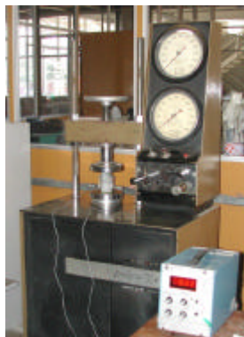
Figura 3.8a – Ensaio para obtenção do módulo de elasticidade (a)
