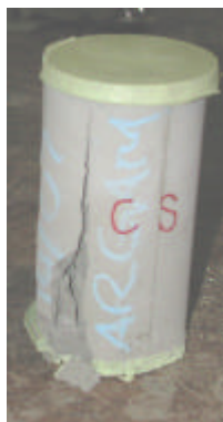
Figura 4.29 – Corpo-de-prova no traço VOL0F0 (argamassa simples) após ensaio
