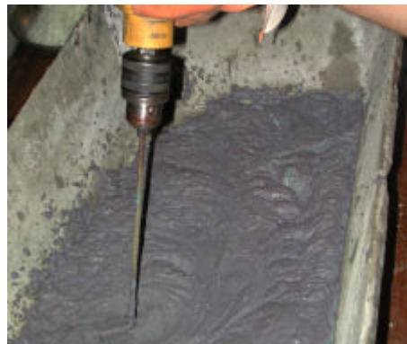
Figura 3.12 – Moldagem utilizando máquina para facilitar a mistura
