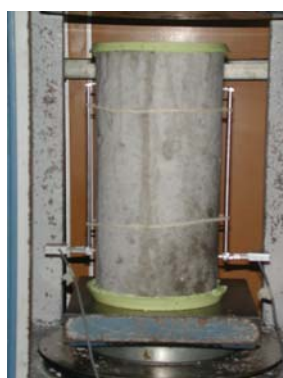
Obtenção do módulo de elasticidade longitudinal do concreto
