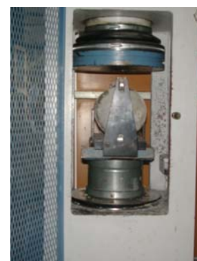
Ensaio à tração do concreto por compressão diametral
