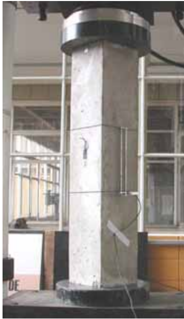
Figura 6.17 – Aplicação do carregamento estático – prisma.
