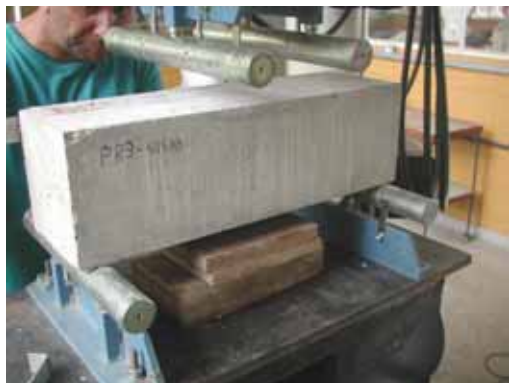
Figura 6.48 – Dispositivo de flexão de quatro pontos – Prismas – Módulo estático.
