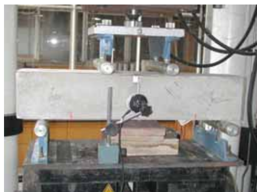
Figura 6.51 – Ensaio estático para determinação do módulo de elasticidade – Prisma 75 cm.
