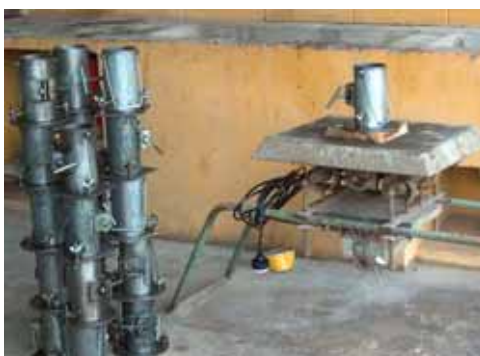
Figura 6.4 – Formas metálicas – CPs cilíndricos. Mesa vibratória.
