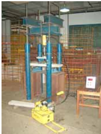
Figura 5.7 – Equipamentos para carregamento à flexão da viga 1.
