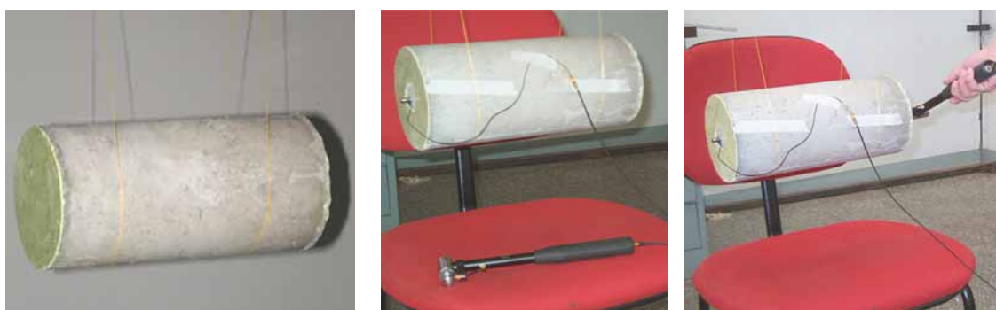
Figura 5.12 – Ensaios dinâmicos realizados com o corpo-de-prova 15 cm x 30 cm, no LabDin.
