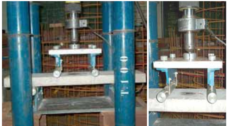
Figura 5.8 – Detalhes da viga 1 – Ensaio à flexão.
