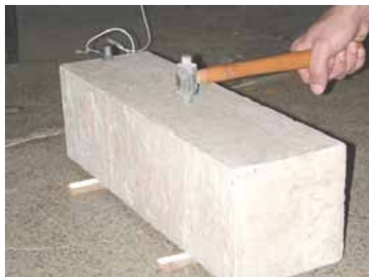
Figura 5.17 – Ensaios com o prisma – frequência transversal – madeira.
