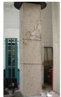
Figura 6.35 – Ruptura por esmagamento do concreto.
