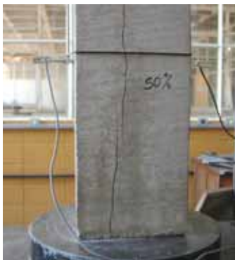
Figura 6.32 – Detalhes da ruptura do prisma – série AR, 124 dias.
