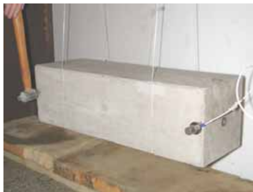
Figura 5.18 – Ensaios com o prisma – frequência transversal – suspenso por fios de nylon.
