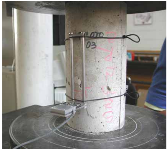
Figura 5.26 – Corpo-de-prova cilíndrico após a ruptura.
