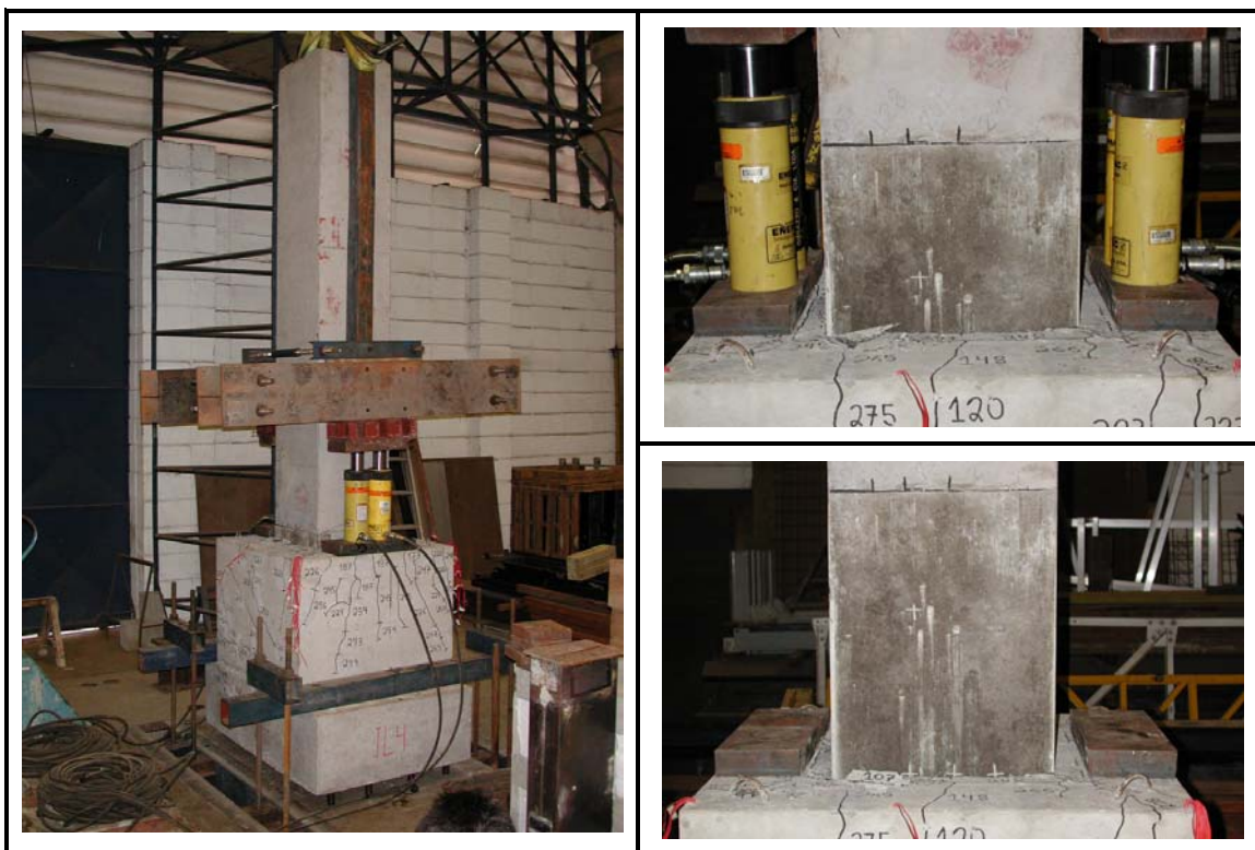
Figura 3.4 – Retirada dos pilares para aproveitamento dos cálices
