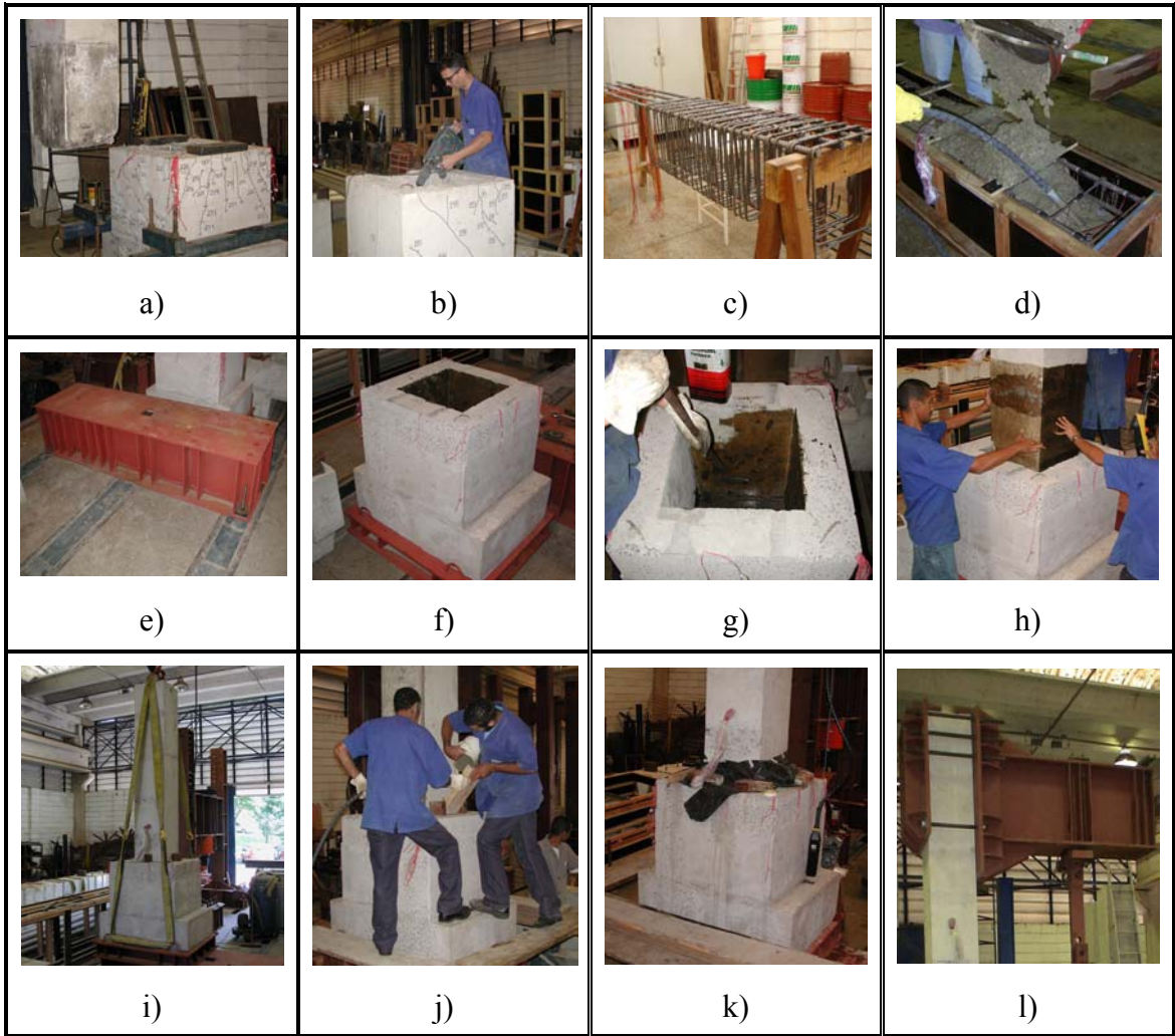
Figura 3.19 – Etapas da execução e montagem dos modelos
