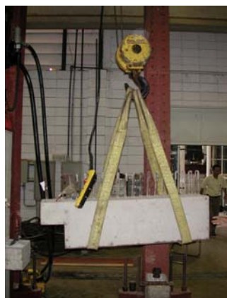
Íçamento da viga
