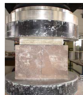
Figura 3.27 - Ensaio da rigidez da placa
