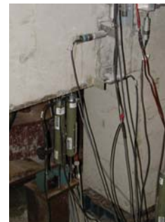
Transdutores sobre a viga e console
