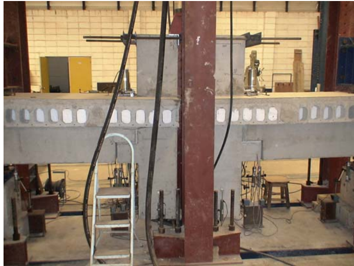
Figura 3.39 - Reforço com perfis metálicos e calço para modelo E
