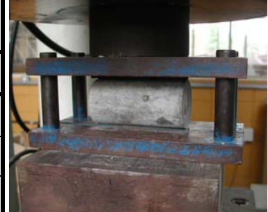
Figura 3.25 - Ensaio à tração por compressão diametral dos corpos-de-prova
