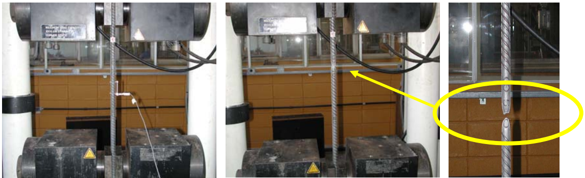
Figura 3.23 - Ensaio para determinação das propriedades mecânicas do aço
