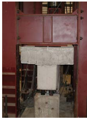
Detalhe da estrutura de apoio superior
