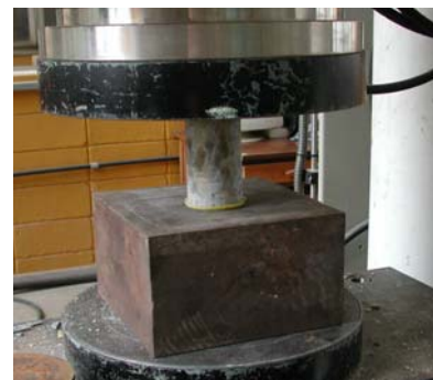
Figura 3.24 - Ensaio à compressão dos corpos-de-prova
