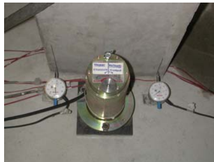
Relógios comparadores e inclinômetros na capa
