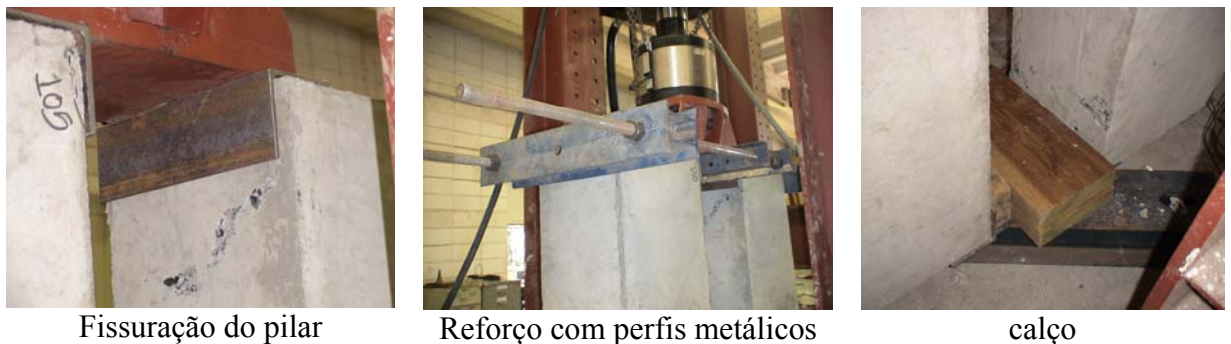
Figura 3.40 - Detalhe do carregamento modelo E
