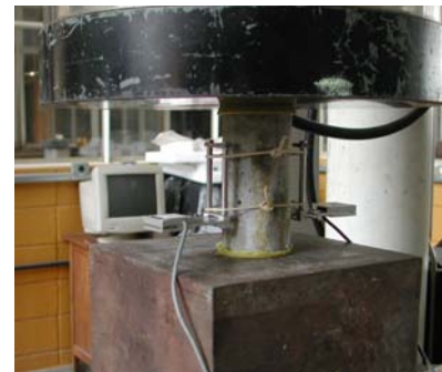
Figura 3.26 - Ensaio do módulo de elasticidade dos corpos-de-prova
