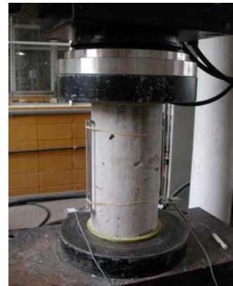
Figura 3.21 - Ensaio de módulo de elasticidade dos corpos-de-prova
