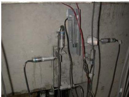
Relógios comparadores e inclinômetros no console
