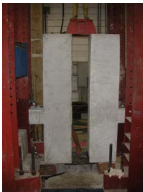
Pilar com chapa e cantoneiras
