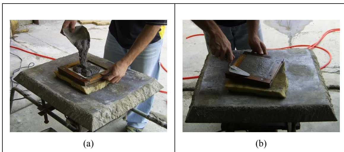
Figura 4.28: (a) Colocação da argamassa na forma; (b) acabamento superficial da almofada.
