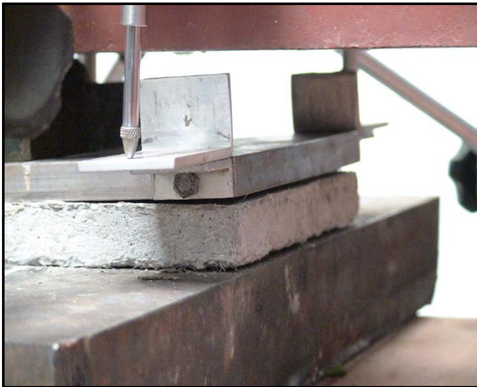
Figura 5.50: Descolamento entre a chapa metálica e almofada de 20mm.
