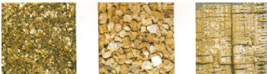
Figura 3.2: Vermiculita: natural, expandida e partícula expandida.
