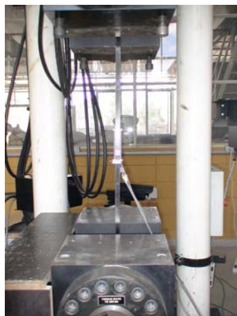
Figura 6.5 - Ensaio para determinação das propriedades no laminado à tração.
