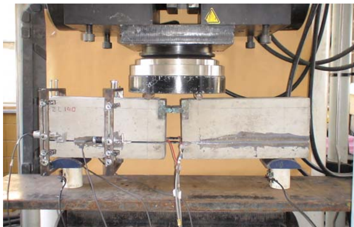
Figura 6.14 - Ensaio de aderência.
