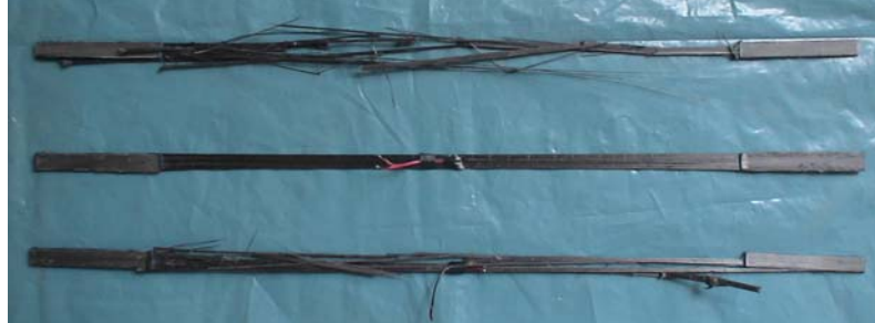
Figura 6.7 - Corpos-de-prova após ensaio de tração.
