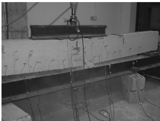
Figura 3.3 - Destacamento do concreto de cobrimento entre duas fissuras na região de momento máximo (Fonte: adaptado de De Lorenzis e Teng (2006)).
