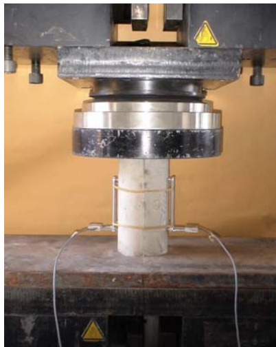
Figura 6.4 - Ensaio para a determinação da resistência à compressão e do módulo de elasticidade.
