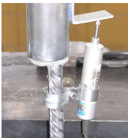
Figura 4.2 – Transdutor inclinado devido a estrição da barra
