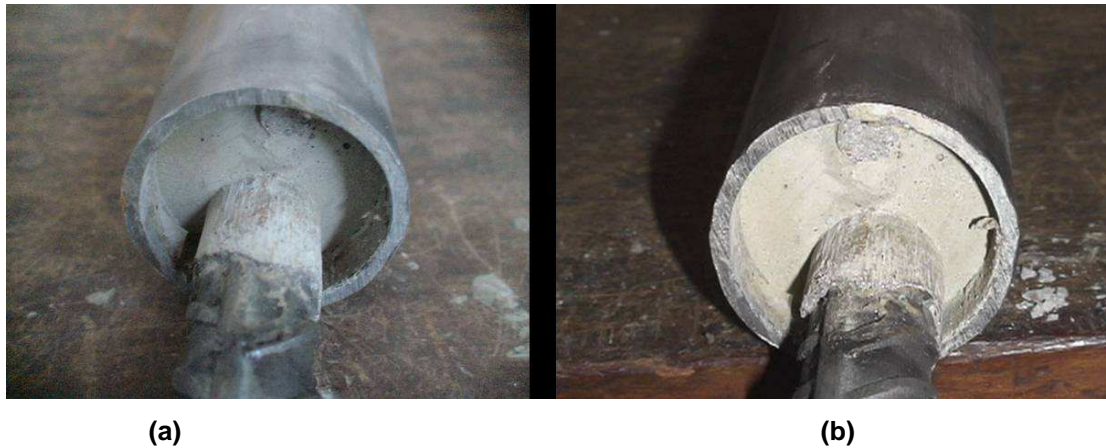
Figura 4.8 – Extremidade não solicitada a) antes do ensaio e b) depois do ensaio, inalterada
