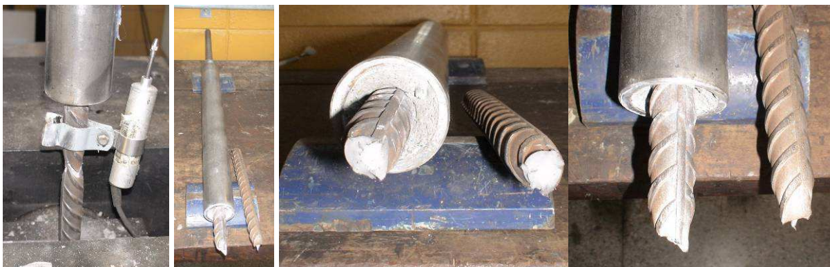
Figura 4.53- Ruptura da barra de aço
