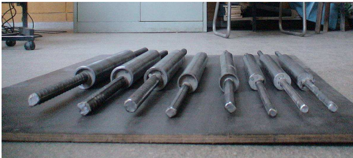
Figura 3.14 – Emendas com variados diâmetros de tubo e barra de aço
