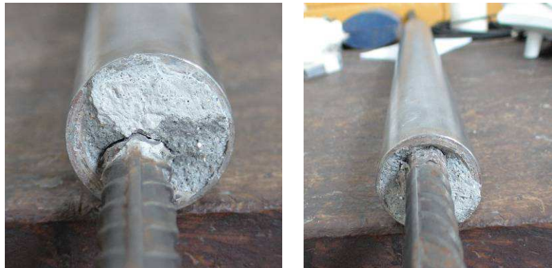
Figura 4.42 – Extremidade não rompida
