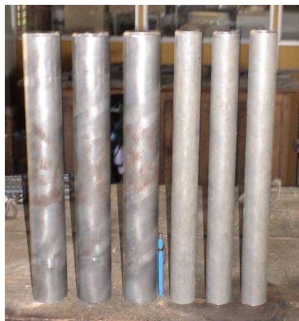
Figura 3.5 – Tubos com diâmetro externo de 60 e 44,5 mm para o ensaio piloto
