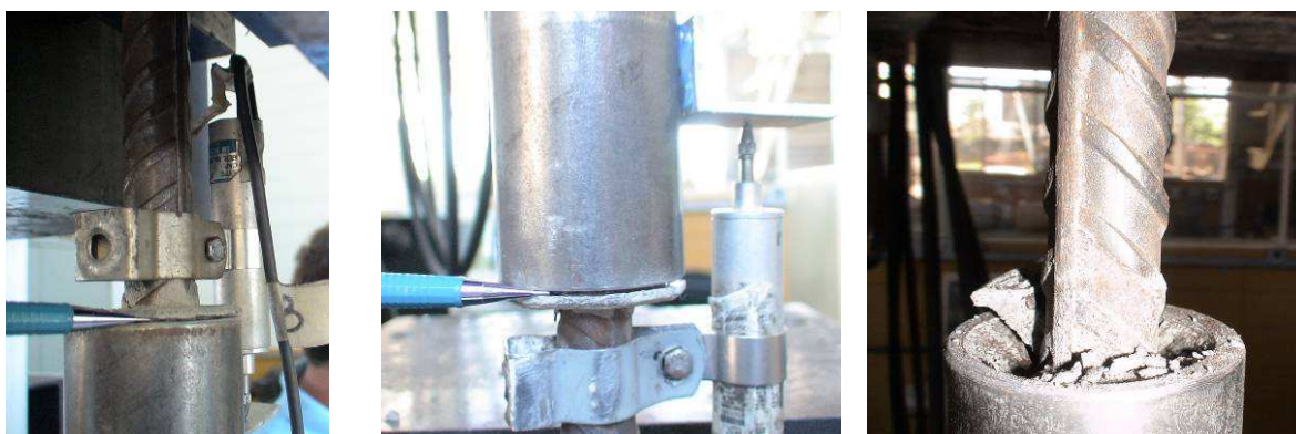
Figura 4.54- Deslizamento e ruptura do graute
