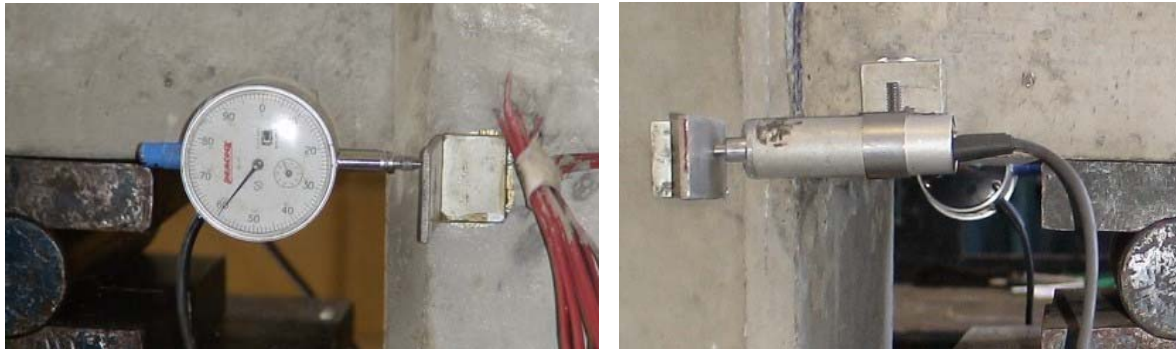
Figura 4.6 - Transdutores de deslocamento para medida da abertura da fissura na interface consolo-pilar.
