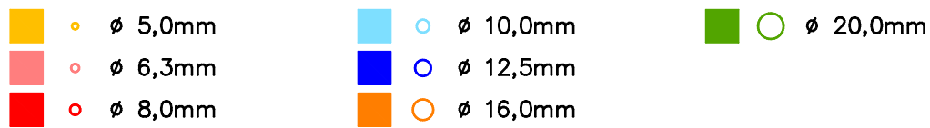
Figura 3.3 - Código de cores das bitolas das armaduras.
