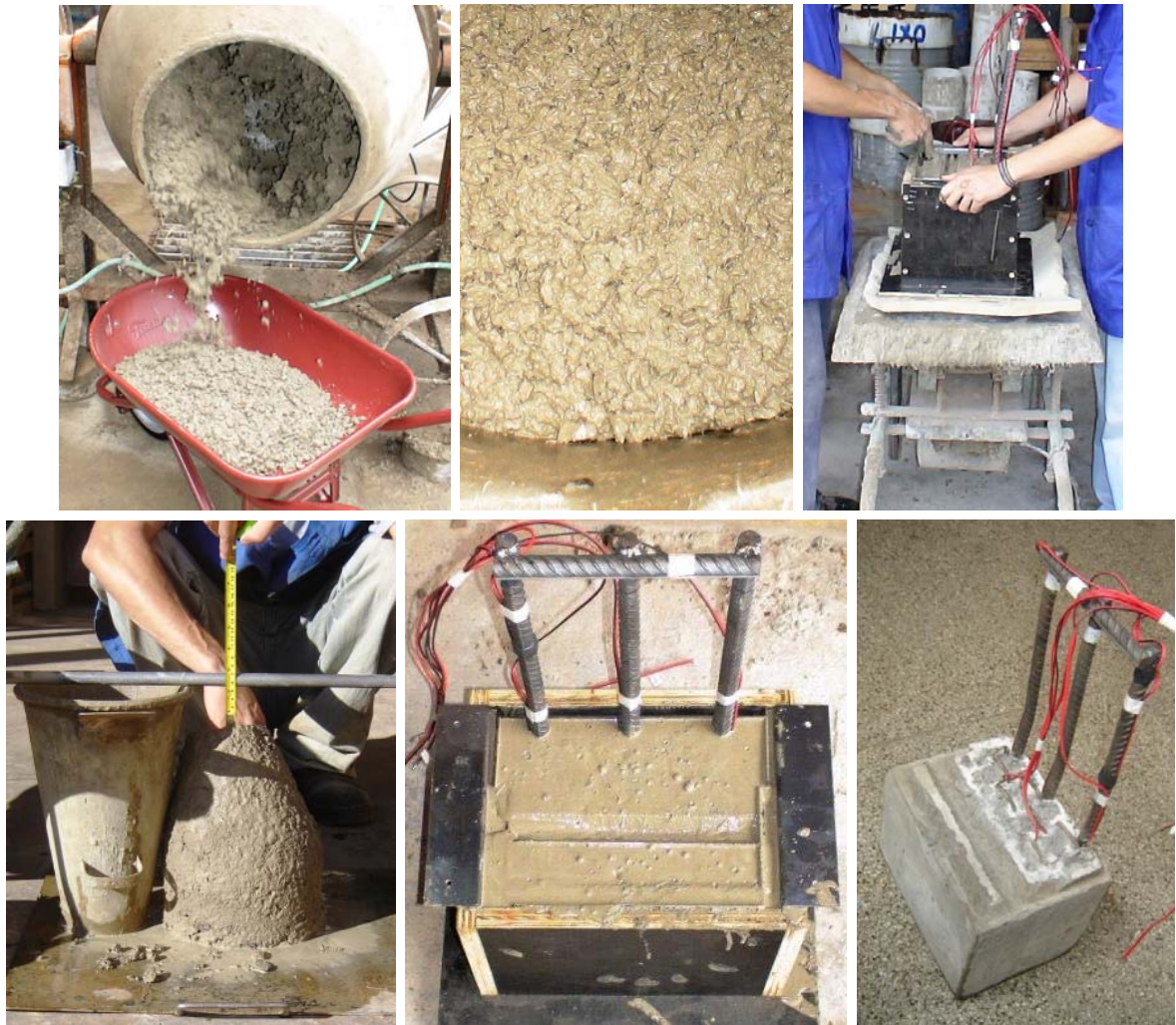
Figura 3.35 - Detalhes da concretagem dos consolos.
