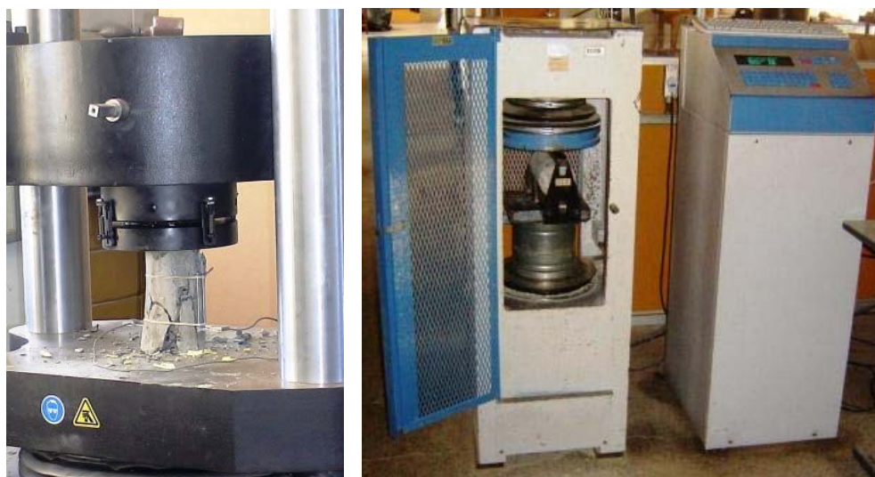
Figura 3.41 - Ensaio dos corpos-de-prova cilíndricos de concreto.
