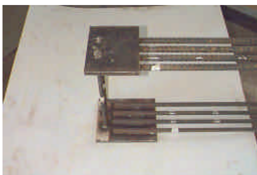
c) Solda das chapas metálicas com as armaduras da viga
