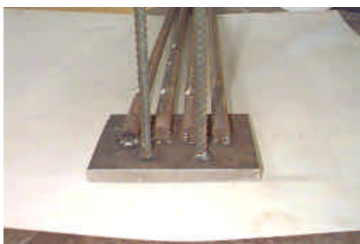
b) Detalhe da solda da armadura negativa da viga
