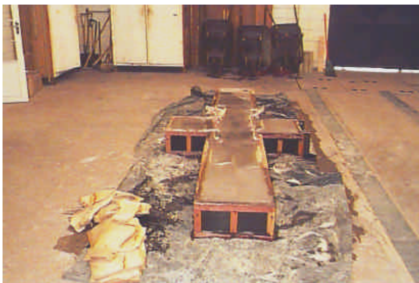
Figura 5.10 – Modelo concretado com a sua lateral na posição horizontal
