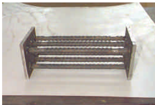
c) Detalhe do elemento de transição do esforço negativo, insertado no elemento de pilar
