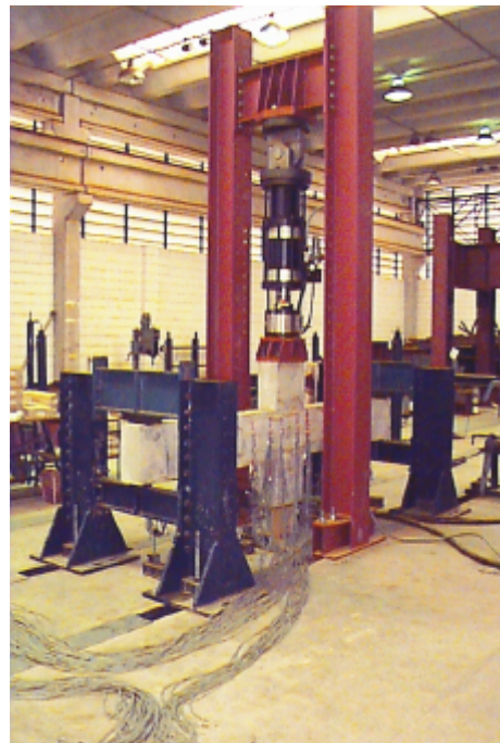
Figura 5.6 – a) Atuador INSTRON 8506 (ações alternadas e cíclicas, com controle de deformações). b) Disposição geral do modelo no pórtico de reação.
