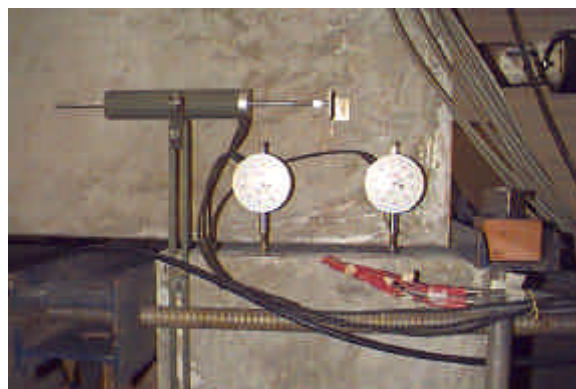
b) Detalhe dos relógios para medição das rotações relativas
