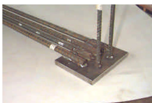
b) Detalhe da solda da armadura negativa da viga
