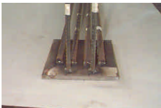
a) Detalhe da solda na armadura positiva da viga
