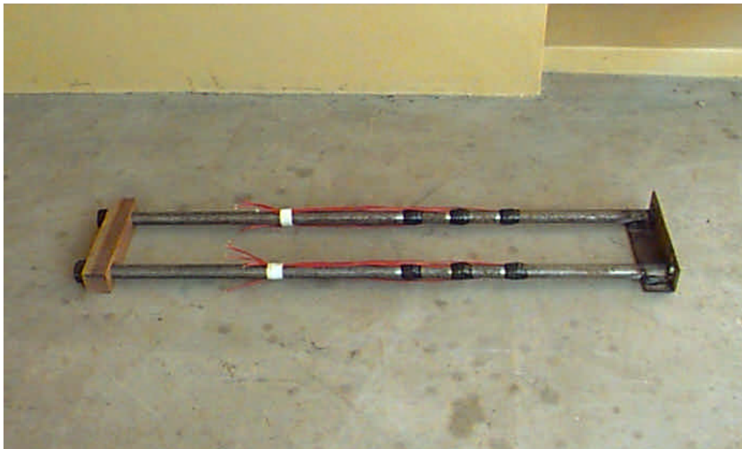
Figura 4.26 – Vista da instrumentação nos chumbadores para os Protótipos B e C
