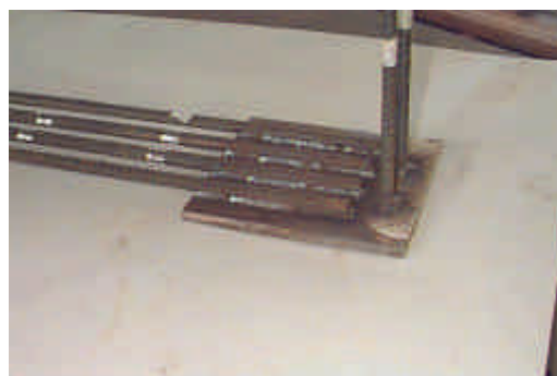
a) Detalhe da solda na armadura positiva da viga
