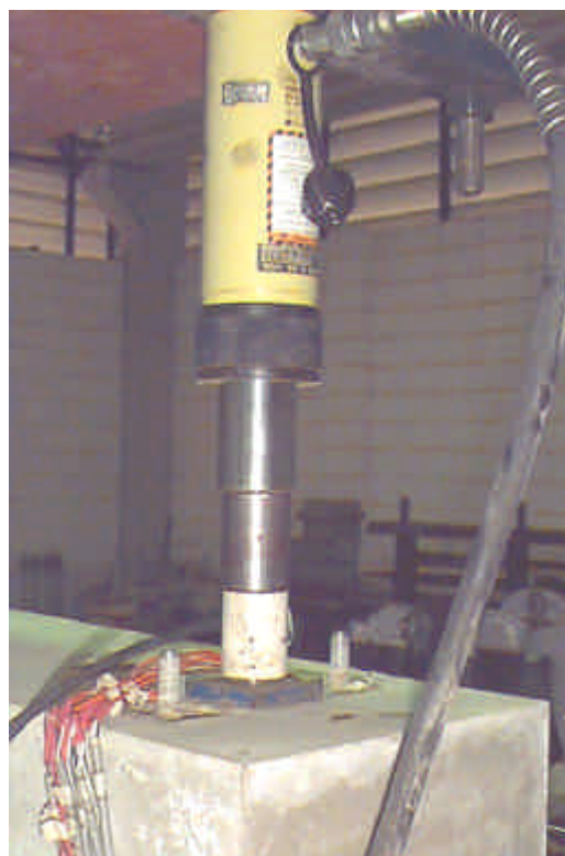
Figura 4.32 – Atuador para aplicação da força normal na ligação.
