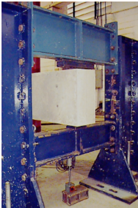
Figura 5.6 – a) Atuador INSTRON 8506 (ações alternadas e cíclicas, com controle de deformações). b) Disposição geral do modelo no pórtico de reação.
