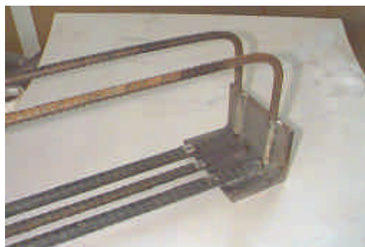
a) Detalhe da ligação com solda na armadura do consolo
