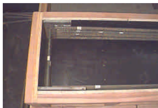
c) Solda das chapas metálicas com as armaduras da viga
