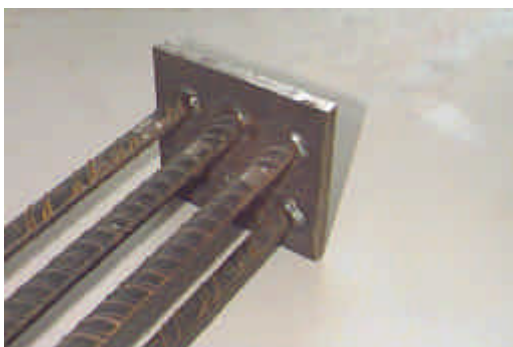
c) Detalhe do elemento de transição do esforço negativo, insertado no elemento de pilar
