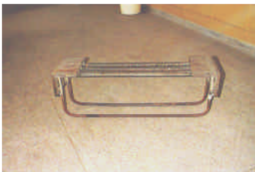
b) Posicionamento da armadura na forma
