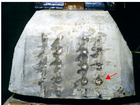
Fig. 8.14 - Escorregamento dos fios de protensão após a ruptura.
