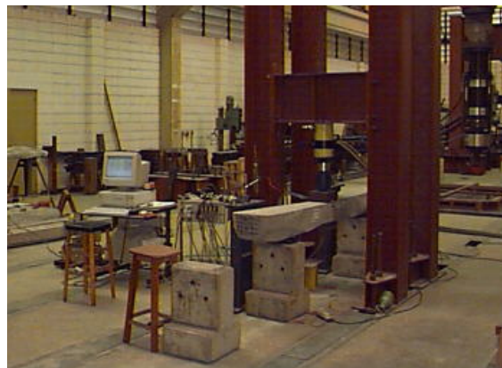
Fig. 8.33 - Execução de um ensaio na seção do centro para momento negativo.
