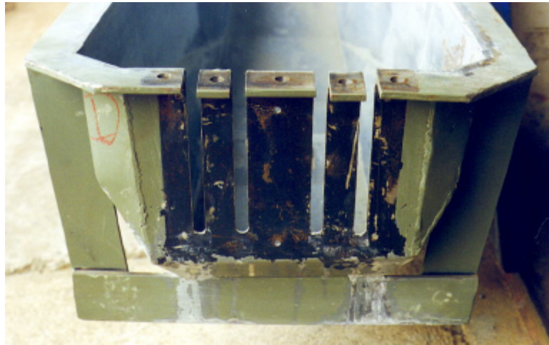
Fig. 7.2 - Detalhe da chapa nas extremidades do molde.
