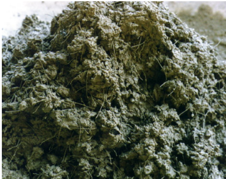
Fig. 7.16 - Homogeneidade da distribuição das fibras de aço no concreto.
