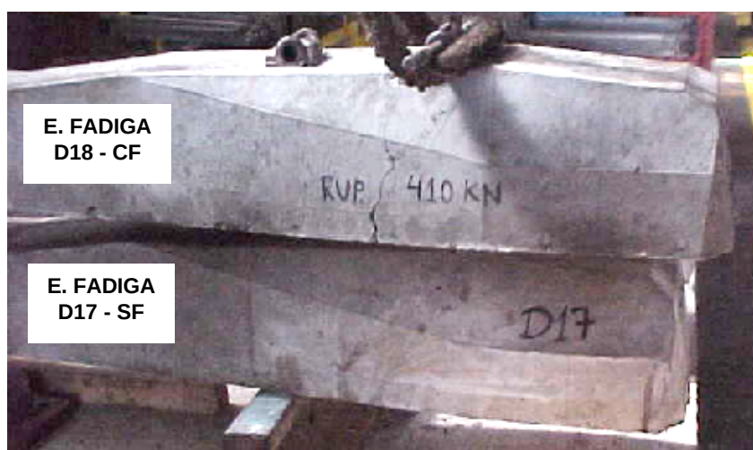
Fig. 8.56 - Configuração final dos dormentes D17 e D18 após o término do ensaio de fadiga.
