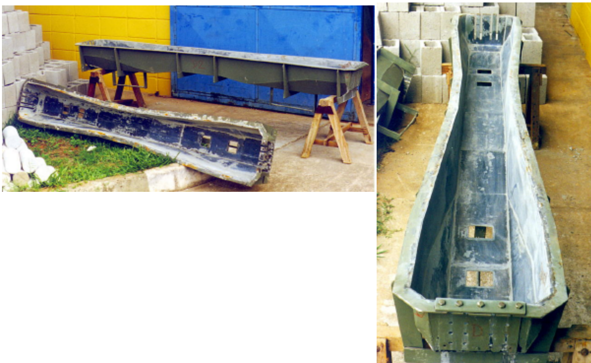
Fig. 7.1 - Moldes metálicos para a fabricação dos dormentes.
