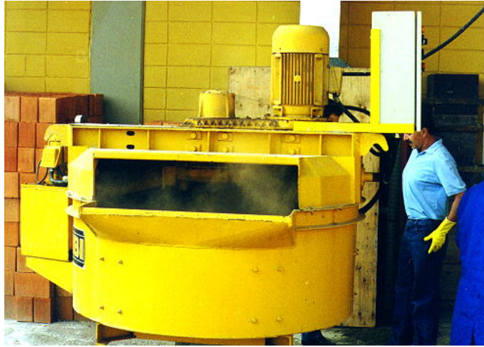
Fig. 7.15 - Betoneira utilizada na mistura.
