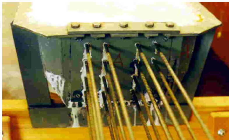
Fig. 7.19 – Vazamento de nata nas extremidades do molde.
