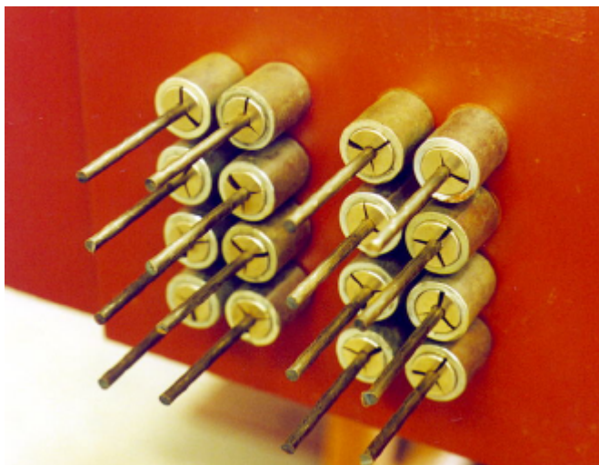
Fig. 7.10 - Fixação dos fios de protensão com cunha e porta-cunha.
