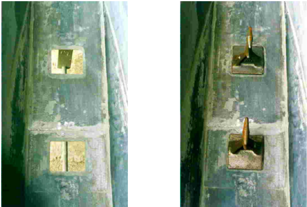
Fig. 7.5 – Posicionamento das ombreiras no molde.
