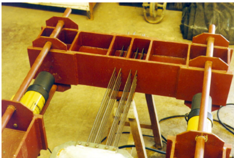
Fig. 7.11 - Cilindros para estiramento dos fios de protensão.
