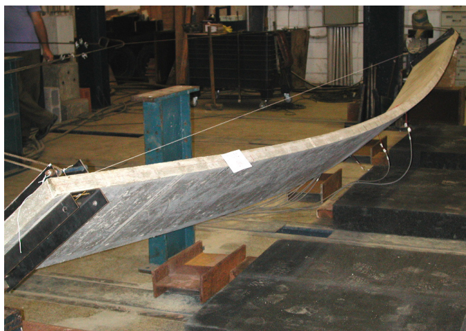
Figura 6.28 – Etapa 10 equivalente à inclinação imposta de 48,86°.
