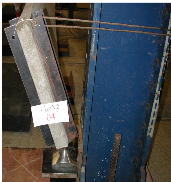
Figura 6.21 – Detalhe (a) da ponte rolante e (b) da fixação do cabo no perfil metálico.
