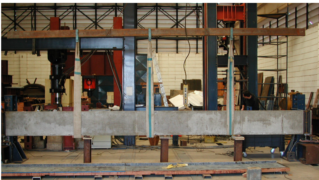
Figura 6.18 – Cintas de içamento igualmente esticadas, presas à viga e ao balancim metálico.
