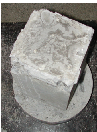
Figura 5. 10: Presença de bolhas de ar na junta.
