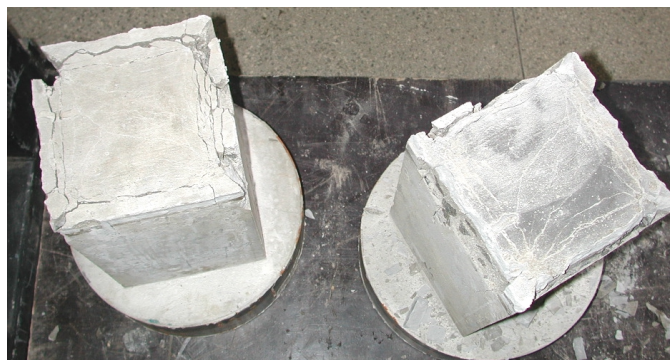
Figura 5. 6: Quebra de aderência na interface segmento superior/junta.
