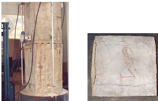
Figura 4. 36: Configuração de ruína do modelo M9AF15SRN-35.
