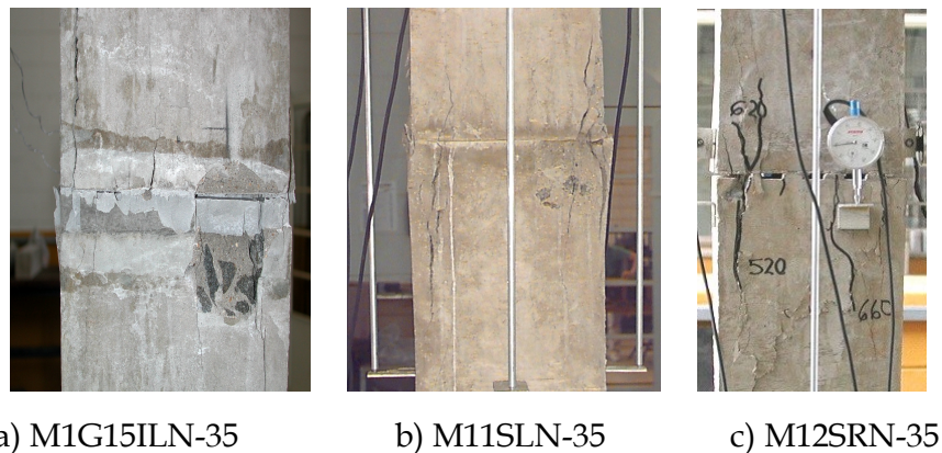
Figura 5. 26: Configuração de ruína dos modelos.
