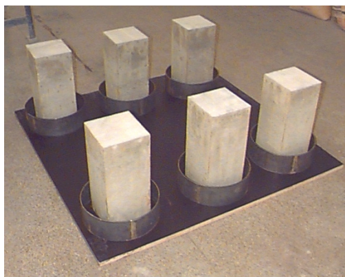
Figura 4. 7: Segmentos posicionados para concretagem dos anéis
