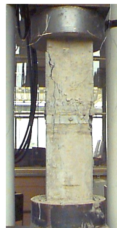
Figura 4. 21: Diagrama tensão x deslocamento do modelo M3G30ILN-35 e configuração de ruína.
