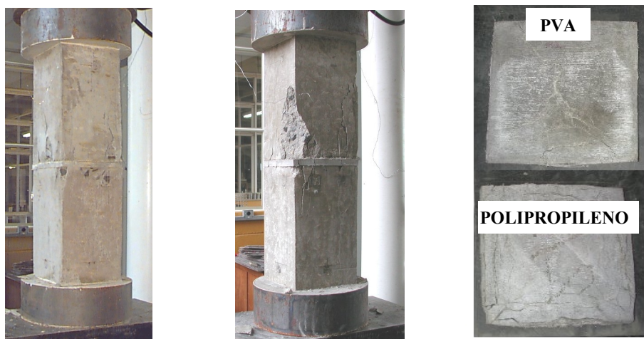
a) modelo com almofada contendo fibra de Polipropileno. b) modelo com almofada contendo fibra de PVA. c) configuração de ruína das almofadas.
