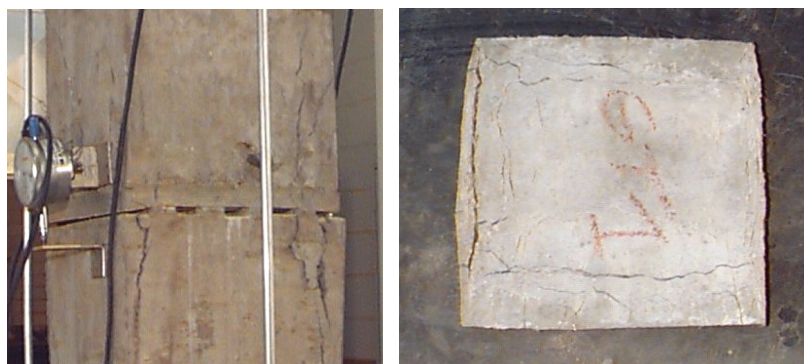
Figura 5. 40: Configuração de ruína do modelo e da almofada de apoio.
