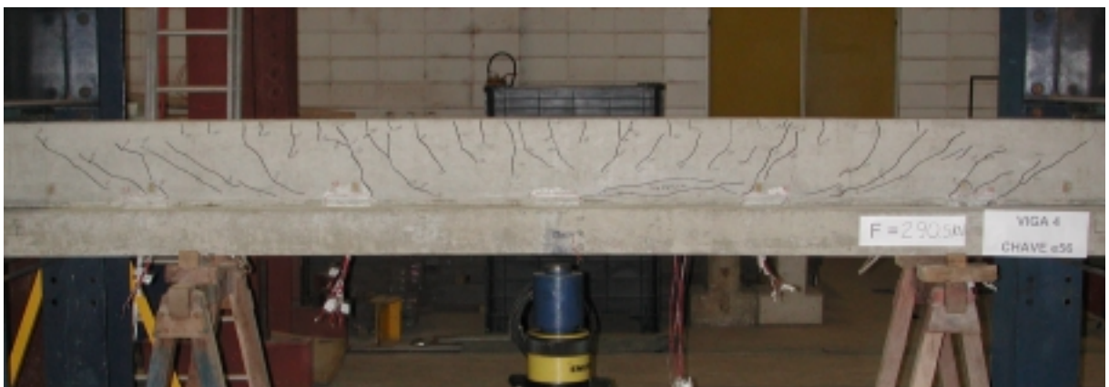
(c) Panorama de fissuração da V4 após a ruptura
