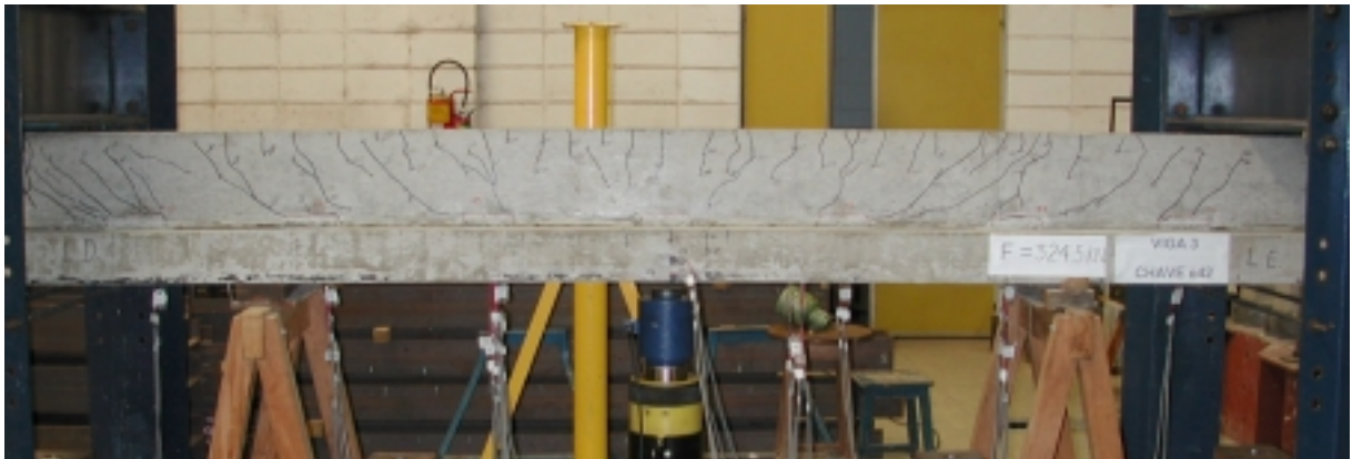
(a) Panorama de fissuração da V3 após a ruptura
