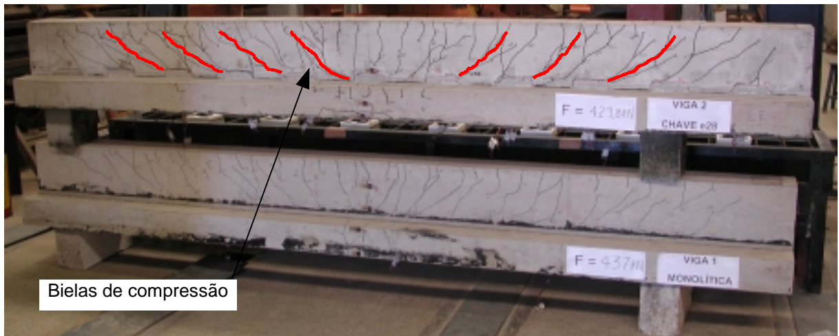
(a) Panorama de fissuração após a ruptura
