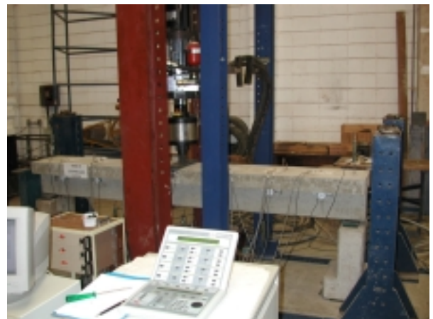
Figura 6.16 – Ensaio da viga composta submetida a carregamento cíclico
