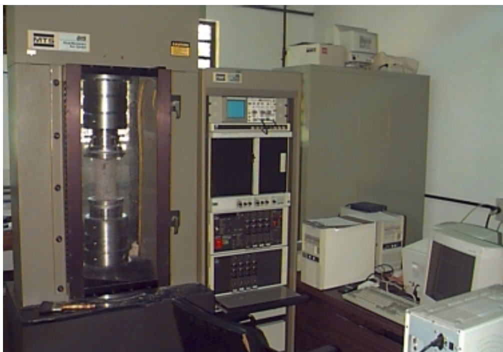
Figura 3.16 – Fotografia do equipamento empregado nos ensaios de compressão uniaxial
