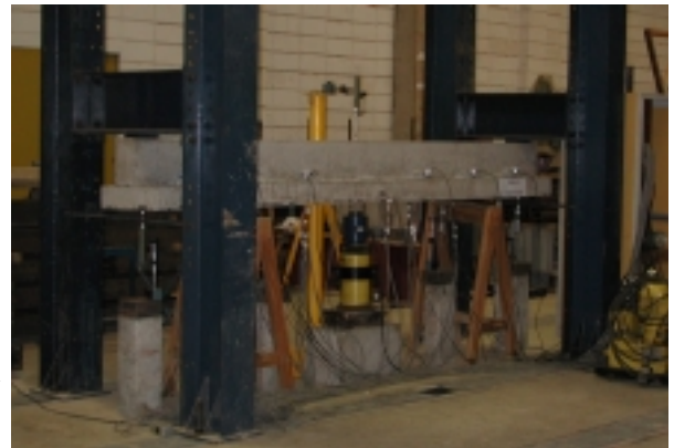
Figura 6.15 - Ensaio das vigas compostas submetidas a carregamento monotônico.
