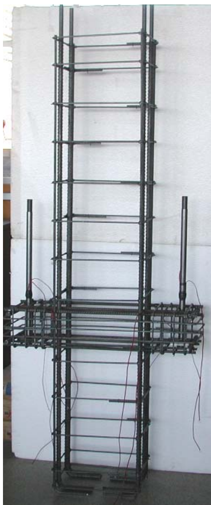
Figura 4.46 - Armadura dos pilares – parte 2 (dimensões em cm).
