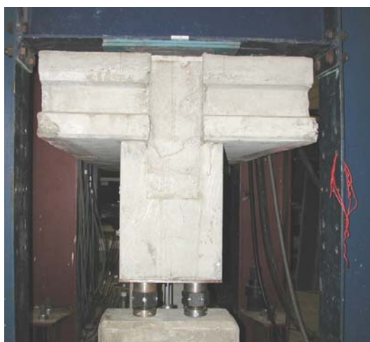
Figura 4.49: (a) - aparelho de apoio do modelo (modelo 2.1);
