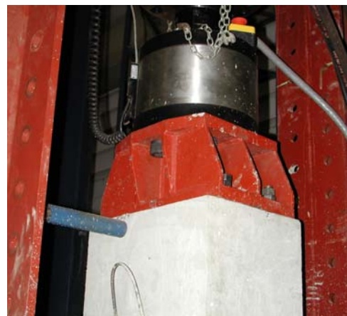
Figura 4.49: (a) - aparelho de apoio do modelo (modelo 2.1);
