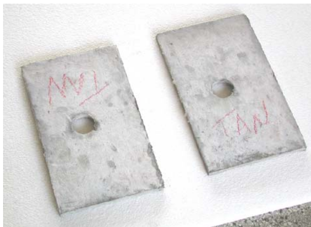
Figura 4.56 - Vista das almofadas de apoio (modelo 2.1).
