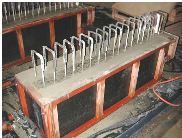
(g) - viga moldada;
