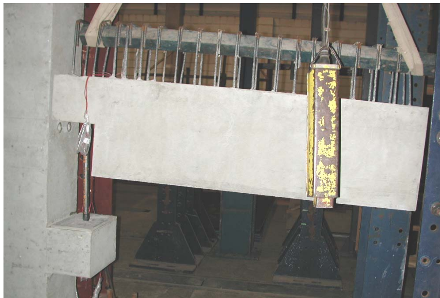
(d) - posicionamento da viga sobre o consolo;
