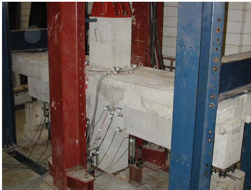
Figura 4.74 - Instrumentação externa do modelo 2.1 - vista.
