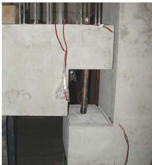
(e) - posicionamento da viga - detalhe; (f) - vista da viga apoiada sobre o consolo;
