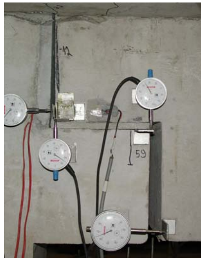
Figura 4.85 - Fissura vertical entre o dente gerber e o graute de preenchimento.
