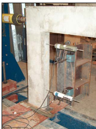
Figura 5.25. Transdutores de deslocamento (esquerda)
