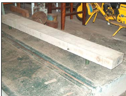
Figura 6.11. Ensaio de vibração da viga
