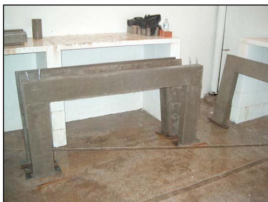
(a) Pórticos na câmara úmida
