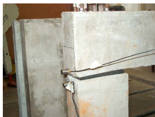
Figura 7.55. Fixação de acelerômetros acima e abaixo da almofada.
