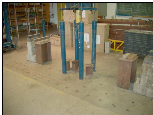
(b) Laje de reação secundária do LE-SET
