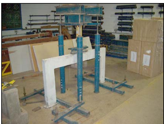
Figura 5.16. Montagem do pórtico para o ensaio de fissuração.
