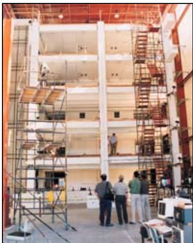
Figura 1.5. Estrutura de ensaio do programa PRESSS-PCI 4 .
