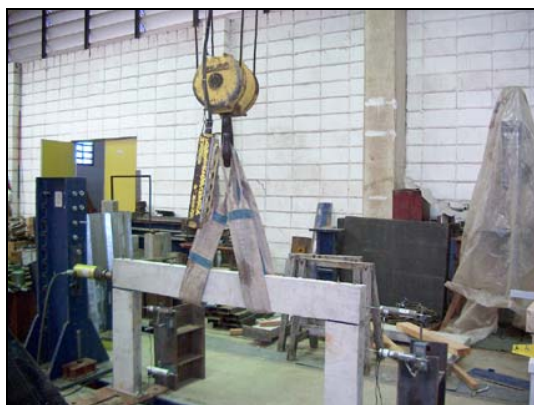
Figura 5.22. Montagem do pórtico para o ensaio de flexão.
