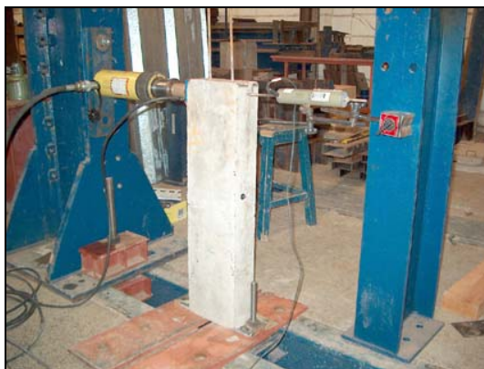
Figura 5.21. Ensaio de flexão dos pilares.
