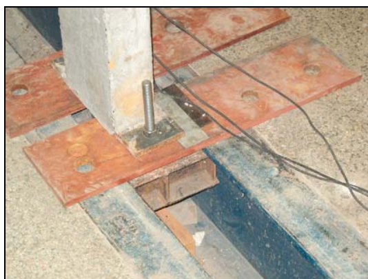
Figura 5.27. Fixação do pórtico.
