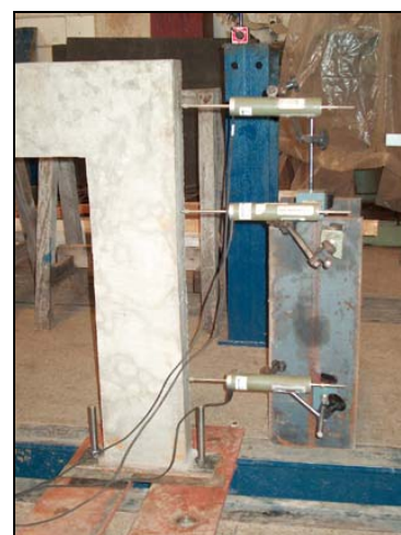
Figura 5.26. Transdutores de deslocamento (direita)
