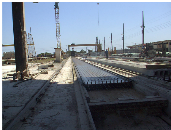
Figura AP-D-2 – Pista de protensão
