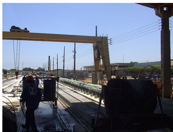
Figura AP-D-6 – Pista de protensão
