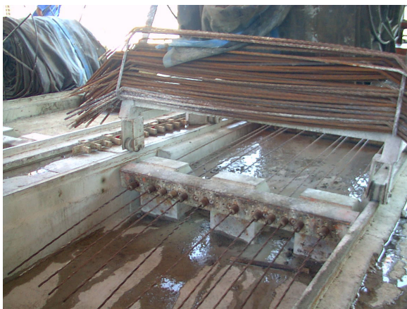
Figura AP-D-1 – Cabos ancorados
