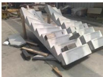
*Figura 2: Escada pré-fabricada de concreto (Fonte: ABCIC)*
