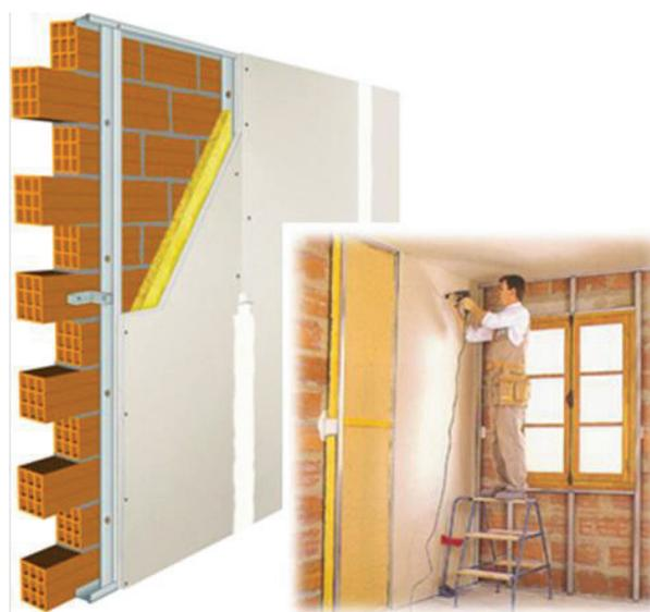
Figura 61: Revestimento estruturado
