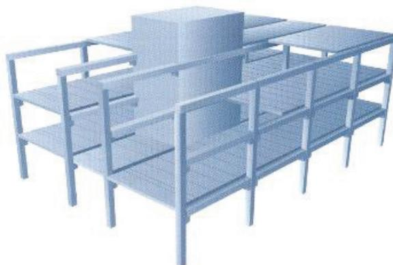
*Figura 66: Sistema estrutural em esqueleto com núcleo rígido (central) (Fonte: FIB, 2014)*
