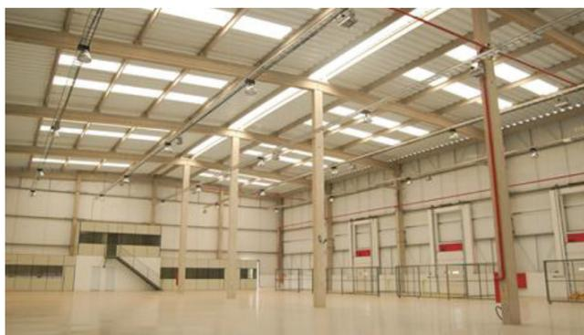
Figura 80: Cobertura com telhas metálicas para vãos menores
