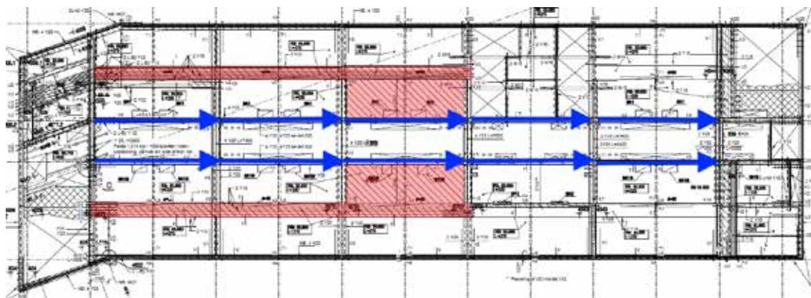
11. 16º andar com área sombreada vermelha sendo de concreto in situ para transferir a força de tração para as paredes longitudinais.
