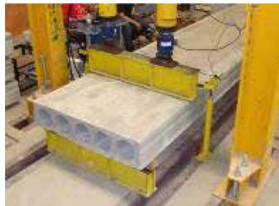
Figura 1: Seção transversal de laje alveolar e ensaio à força cortante
