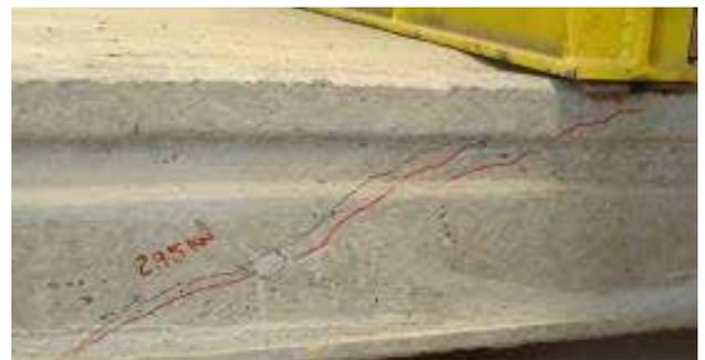
Figura 7: Fissura crítica da ruptura por tração diagonal (sem fissuras prévias de flexão)
