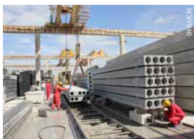
Lajes alveolares na fábrica da United Precast
