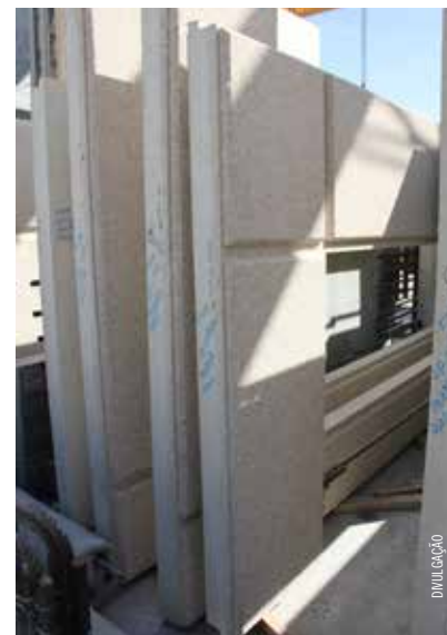
Painéis de fachada na United Precast
