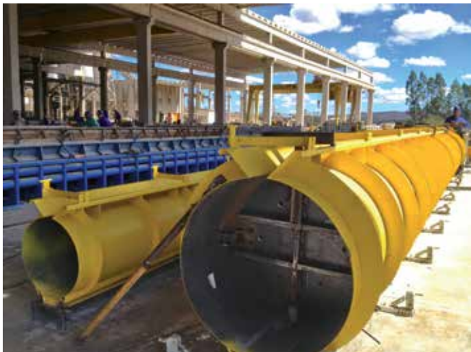
Figura 13: Formas dos pilares pré-fabricados de diâmetro 100 cm
