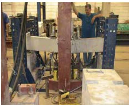
Figura 5 Montagem do modelo na posição normal e modelos sendo ensaiados na posição invertida
