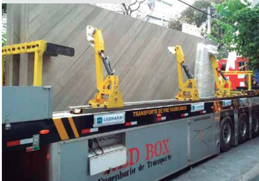
Transporte dos painéis em carreta “in loader”
