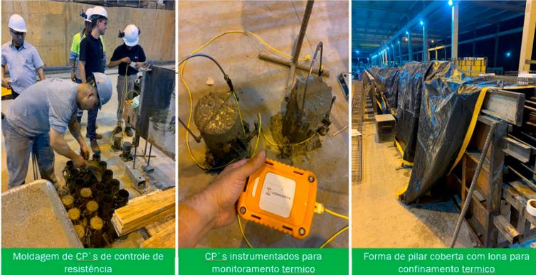
Moldagem de CP's de controle de resistência
