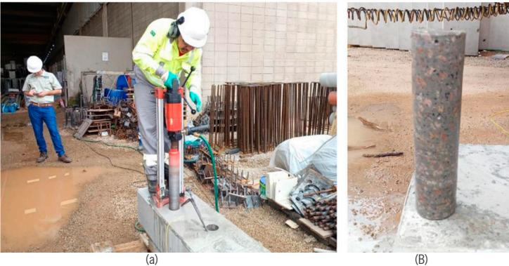
Figura 7 - (a) extração do testemunho da viga; (b) testemunho extraído
