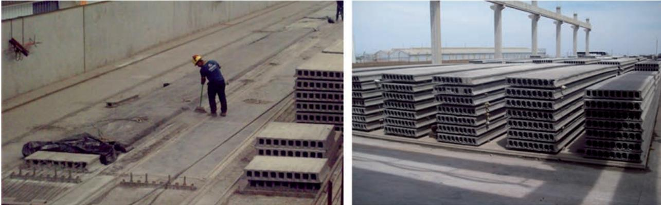
Figura 4. Limpeza da pista de protensão (esquerda); Estocagem das LACP (direita) [Fotos: Direitinho, 2014]
