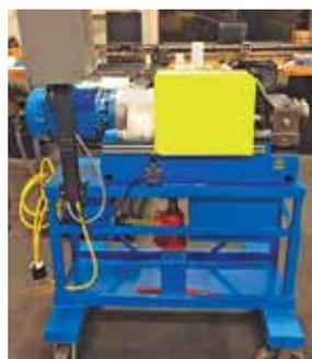
Figura 6 - Máquina para execução da rosca cônica (ERICO, 2011).
