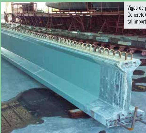
Vigas de pontes executadas na Malásia com Concreto UHPC (Ultra High Performance Concrete) confirmam que o desenvolvimento da tecnologia do concreto é de fundamental importância para que o setor avance ainda mais em suas soluções
