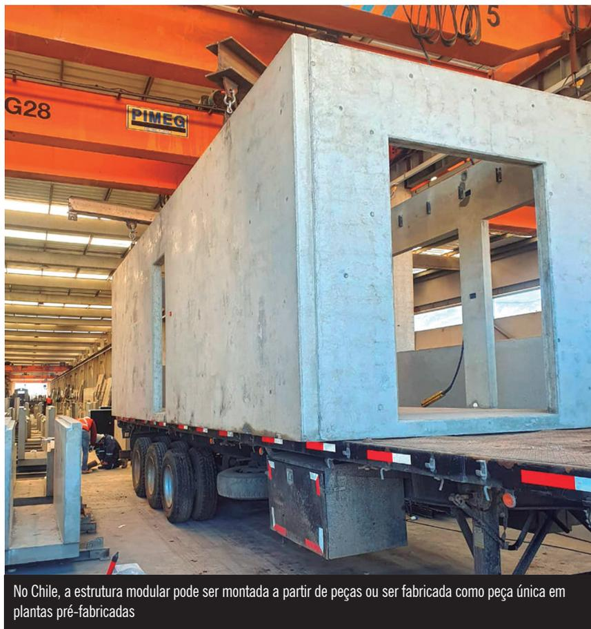
No Chile, a estrutura modular pode ser montada a partir de peças ou ser fabricada como peça única em plantas pré-fabricadas
