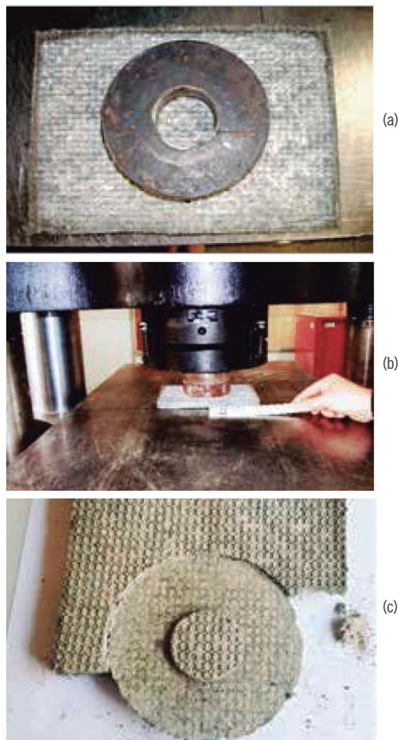
Figura 4 - Almofada submetida à compressão, com disco metálico com orifício central
