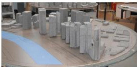
Figura 17 | Modelo da Torre C2 realizado pela RWDI
