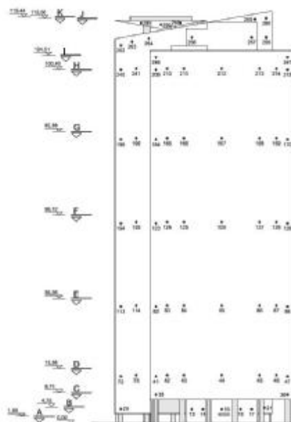
Figura 18 | Fachada Frontal da Torre C1 com pontos de tomada de pressão
