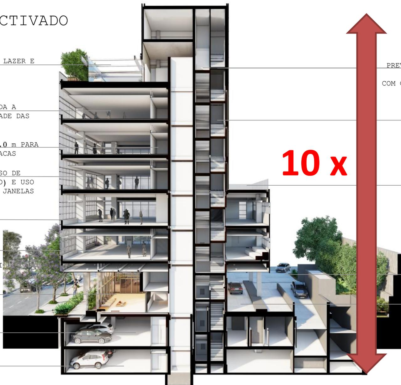
PREVISÃO PARA ELEVADOR DE EMERGÊNCIA PRESSURIZADO, COM CAIXA DE CORRIDA DE 2,60 X 3,00m. DIMENSÕES PARA MACA / LEITO (USO HOSPITALAR)
