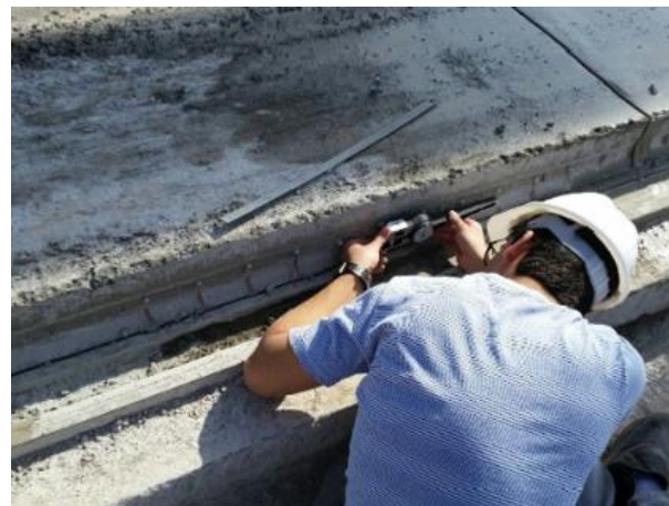
Medições de deformação na fábrica
