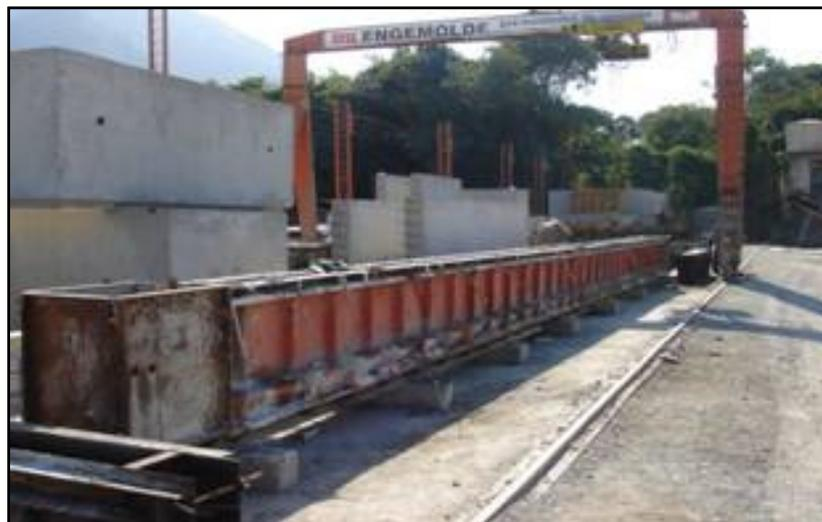
Características fundamentais visando assegurar aspectos dimensionais e visuais (acabamentos das peças). Inspeccionar nesta etapa de produção é fundamental.
