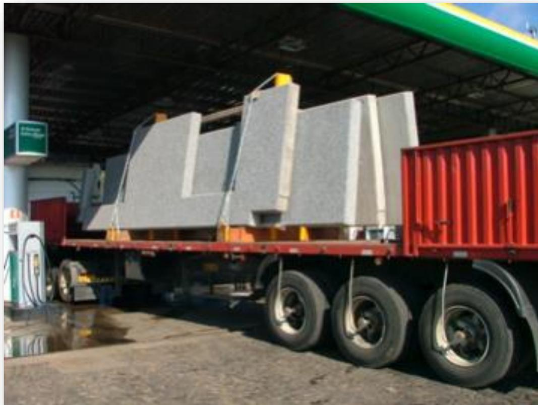
*Fig.16. Exemplo de painel transportado em cavalete tipo "A". Notar travamento temporário.*
