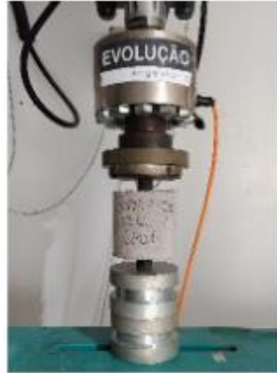
ABNT NBR 16939 Concreto reforçado com fibras Determinação das resistências à fissuração e residuais à tração por duplo puncionamento
