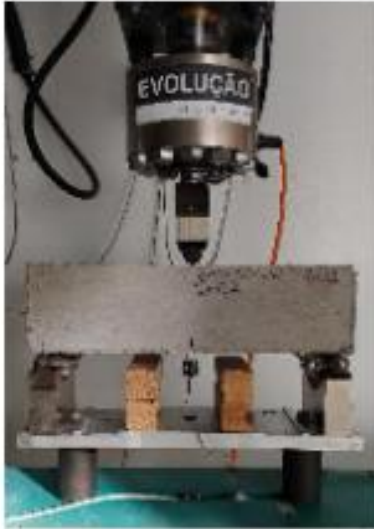
ABNT NBR 16940 Concreto reforçado com fibras Determinação das resistências à tração na flexão (limite de proporcionalidade e resistências residuais)
